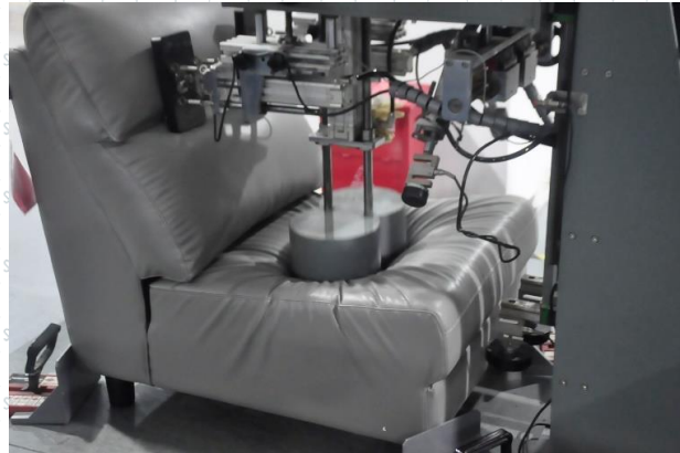
沙发座、背及扶手耐久性试验
